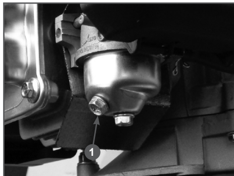
Рис. 19 Слив топлива из карбюратора
