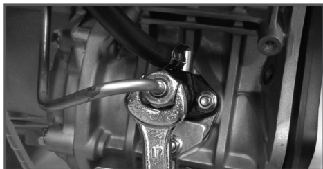
Рис. 12 Удаление воздуха из топливного насоса
