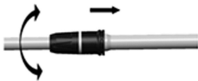
Рис. 5 Установка длины телескопической штанги
