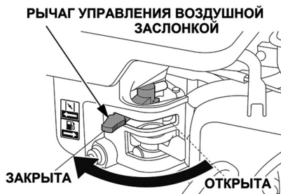
Рис. 9 Воздушная заслонка закрыта
