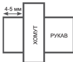
Рис. 6 Расположение хомута на рукаве
